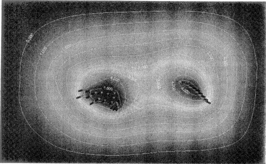
Figura 5. Distribuzione degli abbassamenti piezometrici indotti dalla simulazione dei 2 campi pozzi in esercizio ad una portata complessiva di 500 L/s; in bianco le isolinee di ugual abbassamento piezometrico (equidistanza di 0.5 m).
