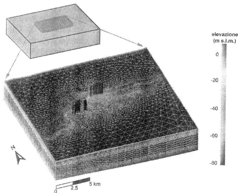
**Figura 6.** Vista assonometrica della porzione della griglia tridimensionale agli elementi finiti nelle aree adiacenti ai pozzi. Il colore degli elementi è rappresentativo dell'elevazione rispetto al mare. È evidenziata la posizione dei pozzi di emungimento e la scala verticale nel particolare è amplificata di 40 volte rispetto a quella orizzontale.
