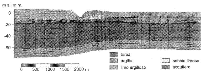
Figura 7. Sezione verticale della griglia del modello di flusso attraverso il campo di Guarda Ferrarese con direzione Nord-Sud. Sono evidenziate con diversa colorazione le litologie di riferimento. La scala verticale è amplificata di 20 volte rispetto a quella orizzontale.
