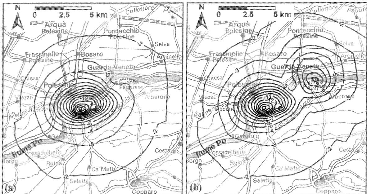
Figura 9. Ricostruzione modellistica della subsidenza antropica prodotta dai campi pozzo di Ro e Guarda Ferrarese (a) al 2005 e (b) al 2035.
