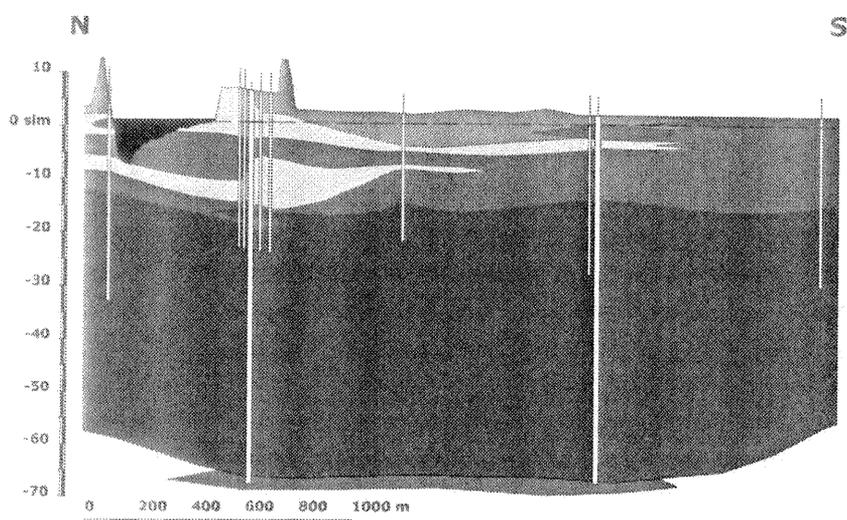
Figura 2. Profilo idrogeologico trasversale al Po presso la golena di Guarda Ferrarese. In arancio: limi e limi argillosi; in magenta: argille; in viola: torbe; in rosso: sabbie; in giallo: limi sabbiosi e sabbie limose; la linea tratteggiata indica il livello piezometrico dell'acquifero in pressione (rosso) misurato a ottobre 2004.
