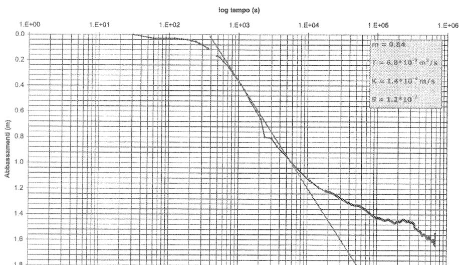
Figura 3. Relazione abbassamenti-log(tempo) per un piezometro di osservazione della prova di acquifero di lunga durata nella golena di Guarda Ferrarese.
