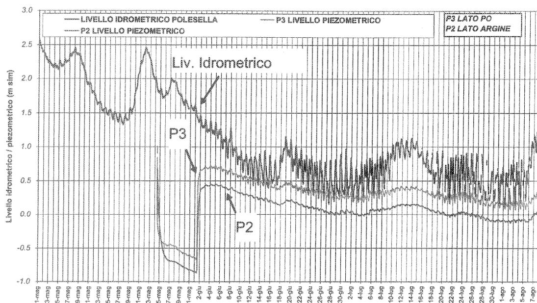
Figura 4. Monitoraggio in continuo del livello del Po a Polesella (in blu) e di 2 piezometri durante l'emungimento e la successiva risalita del pozzo-pilota a Guardia Ferrarese.
